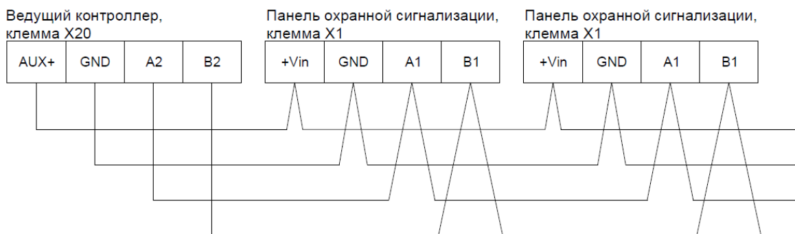
Рисунок 6. Подключение панелей охранной сигнализации ААМ-IO-16/2, подключаемых на один шлейф к ведущему ААМ-LAN-8W/2RS.
