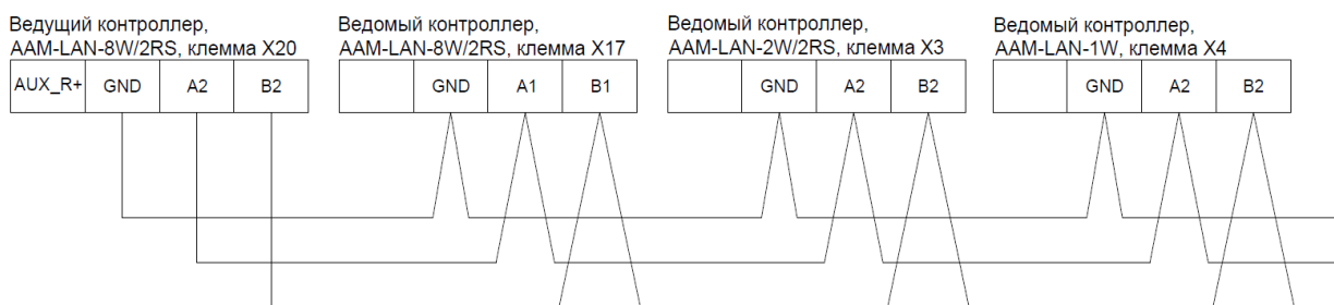
Рисунок 3. Пример подключения ведомых AAM-LAN-8W/2RS к ведущему AAM-LAN-8W/2RS.
